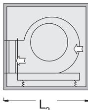
**Вентилятор с регулируемым двигателем с внешним ротором** (необходимы ступенчатый трансформатор и ступенчатый переключатель)
