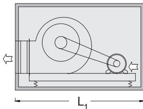
**Вентилятор с клино-ременной передачей и 3-х фазным двигателем односкоростным или с переключаемыми полюсами (с 2 или 3 скоростями)**
