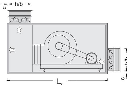
**Вентилятор с клино-ременной передачей или вентилятор с регулируемым приводом на валу,** (необходимы ступенчатый трансформатор и ступенчатый переключатель)
